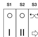
Der Schalter S3 setzt die Funktion "Freie Kühlung" (Bypass) in Betrieb, in dem er die Wechselluftströmung unterbricht, sodaß das Gerät auf Weise "nur Abluft" oder "nur Zuluft" arbeitet, um den Wärmetausch zu vermeiden, wenn er nicht verlangt wird. Der Led auf der frontalen Seite zeigt, daß die Funktion "Freie Kühlung" aktiv ist (abb. 20A-20B).
